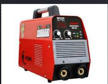
شدت جریان مناسب با قطر الکترود مصرفی و روی دستگاه جوشکاری تعیین می شود .
